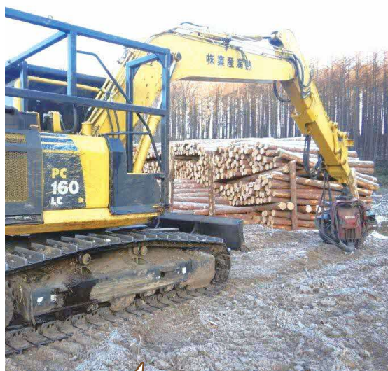
木を倒して枝を払いながら丸太にする機械です
